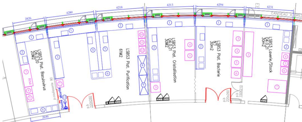
Figure 1 - Schéma des installations dans le laboratoire existant (ref. Plan annexé : LSBS3 1/3 O4.0.20 – O4.0.21)
